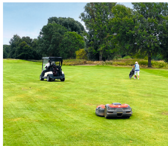
Abb. 13: Leichter Mähroboter (lightweight mower) mit GPS-Steuerung und variabler Schnitthöhe. Auch hier sind definierte Schnittmuster möglich.
