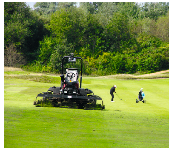
Abb. 14: Herkömmlicher Fairway-Mäher ausgestattet mit einer GPS-unterstützten Steuerung zum autonomen Fahren.
